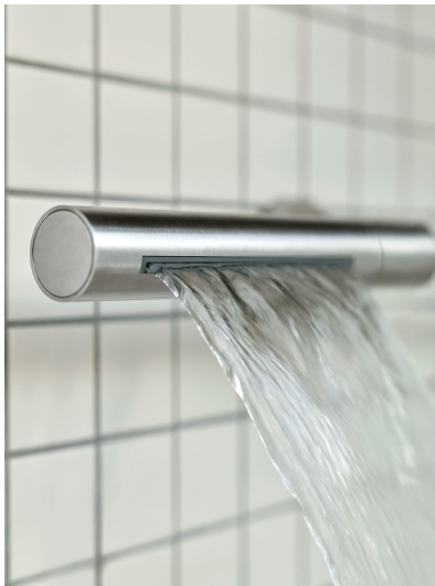
080W Schwallbrause für Wandmontage. Anschluss 3/4", Mindestdurchflussmenge 14 l/min, inkl. Schubrosette.
