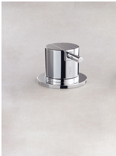
500 Eingriffmischer für Tischmontage. Edelstahlmantel-Anschlusschläuche 3/8", Lochbohrung 42 mm für kleine Durchflussleistung wie z.B. Waschtischarmaturen.
